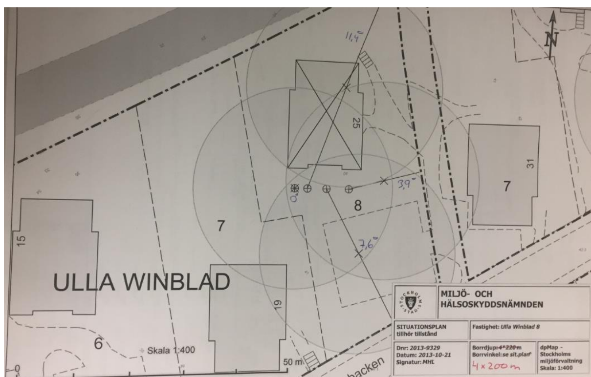
Figur 27 Situationsplan över borrhål till Brf Klubbåsens bergvärmepump.
