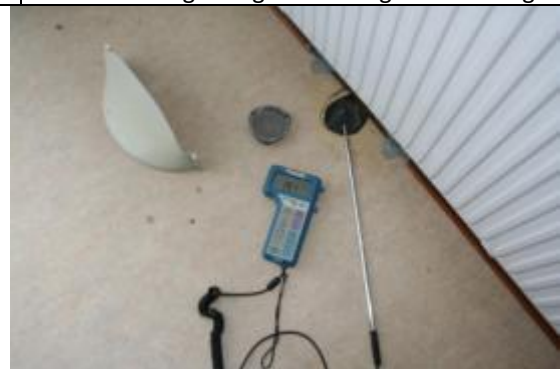
Bild 9b. I sovrum uppmättes lufthastighet kring 2 m/s i tilluftsöppning. (Överluft från andra lägenheter). 2 m/s motsvarar ca 9 l/s i öppningen.
