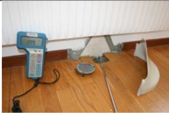
Bild 10a. I vardagsrum mättes 2 m/s i motsvarande ca 9 l/s i ena öppningen.
