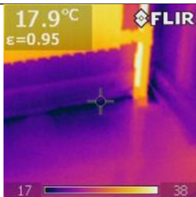
Bild. Otäthet mellan golvsoc­kel och golv.
