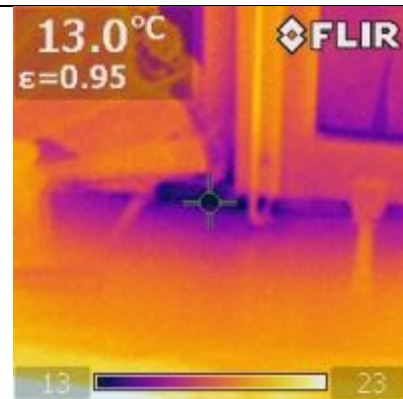
Bild 3a. Läckage vid fönster, mellan båge och karm.
