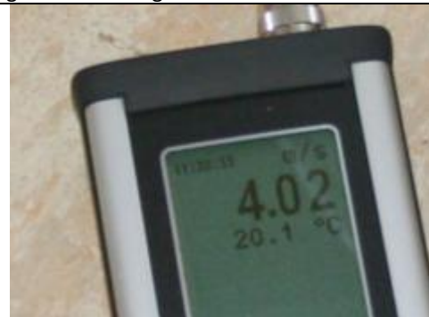
Bild 11a. Tilluftsdon i sovrurn var provisoriskt tätat med glasull och skumplast. Vid mätning med tillfälligt borttagen tätning mättes ca 4 m/s i donöppningen och lufttemperaturen till ca +20°C vilket indikerar att det är överluft från andra lägenheter.
