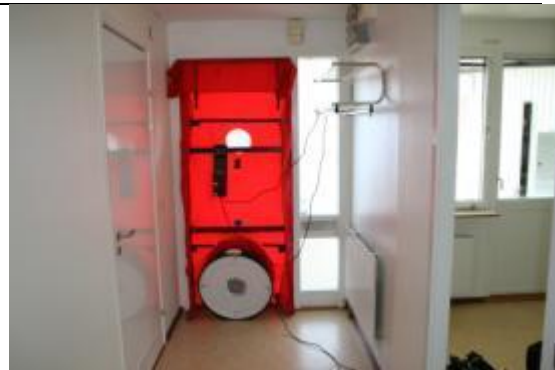
Bild 2. Provtryckningsfläkt, monterad i dörröppning för ytterdörr, upprätthåller undertrycket -50 Pa under provningen.
