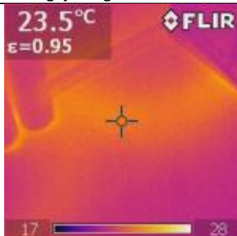
Bild 19a. Trots låg framledningstemperatur blir yttempertur på golv relativt hög (23,5°C) pga värmeförluster från den ingjutna rörslangan.
