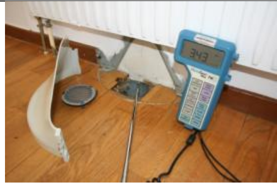
Bild 10b. I vardagsrummets andra golvöppning uppmättes 3,4 m/s motsvarande ca 15 l/s i öppningen.
