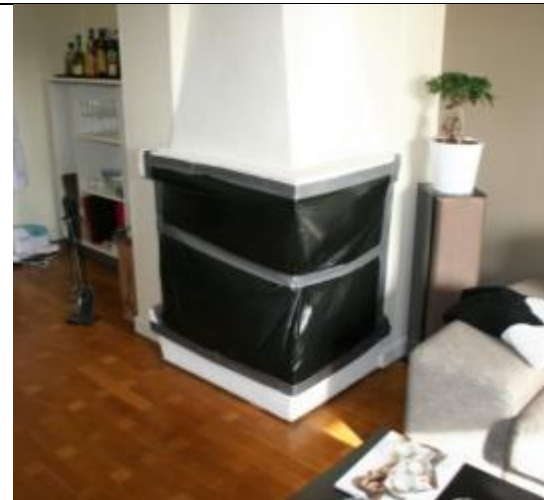
Bild 5b. Ingen skillnad i läckluftflöde kunde dock noteras med tätad respektive otätad öppen spis.
