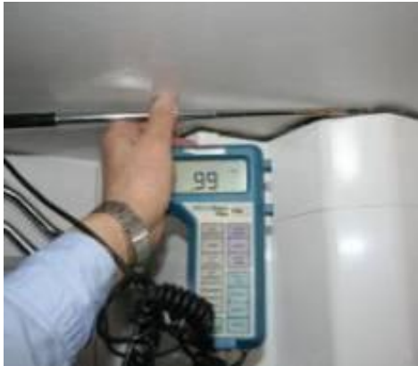
Bild 3. Läckluftflöden från angränsande lägenheter och andra utrymmen lokaliserades genom att känna med handen samt med rökflaskor (RFA) och lufthastighetsmätare (TSI).
