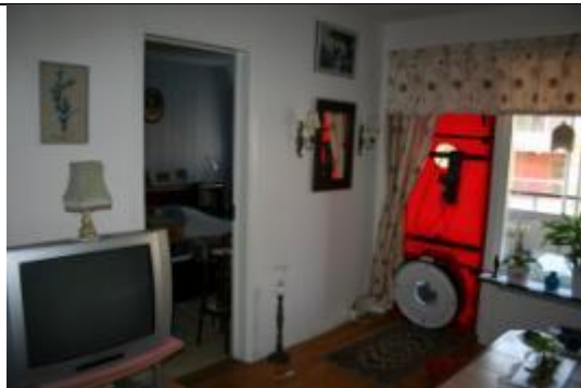
Bild 3a. Blower Door placerades i öppning för balkongfönster.
