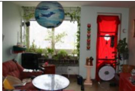
Bild 2b. Vardagsrum. Blower Door placerad i öppning för balkongdörr.
