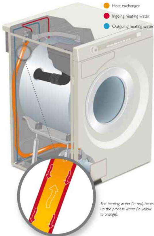
Figur 9 ASKO Appliances AB s tvättmaskin. Värmevattnet (rött) och processvattnet (gult till orange) 15
