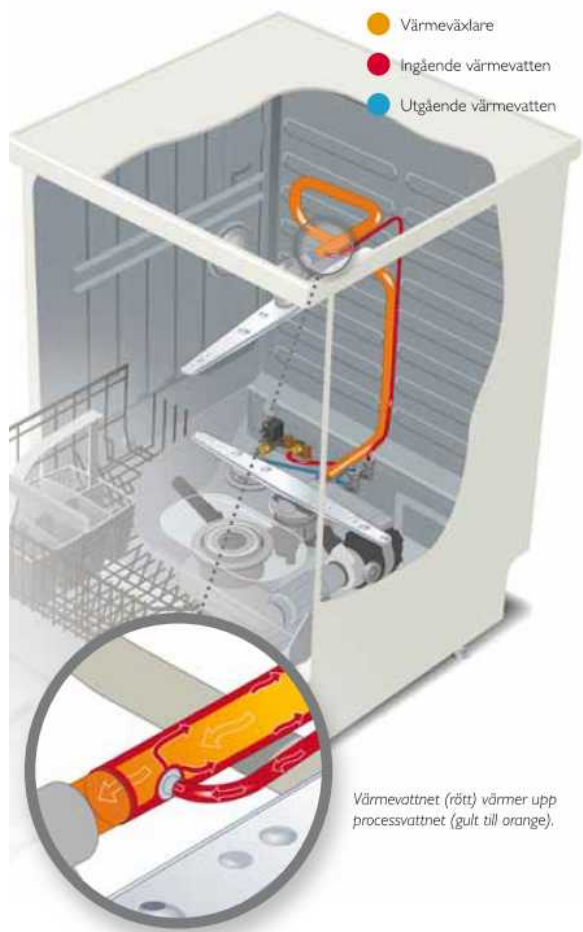
Figur 8 ASKO Appliances ABs diskmaskin. Värmevattnet (rött) och processvattnet (gult till orange) 14
