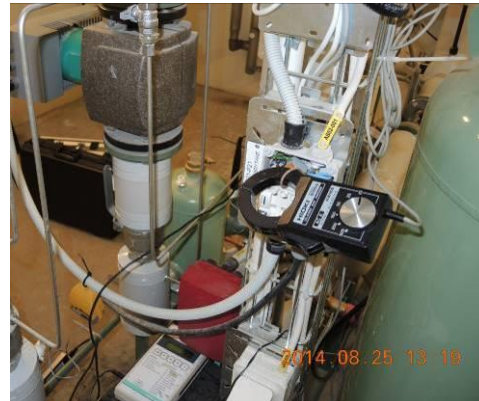
Bild 8. Loggning av ström till pump VS21.
