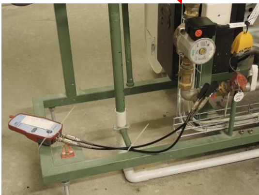
Bild 5. Loggning av VVC-förluster.
