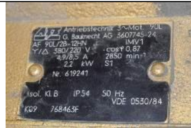
Bild 2. VVC-pumpen har märkeffekt 2,2 kW.
