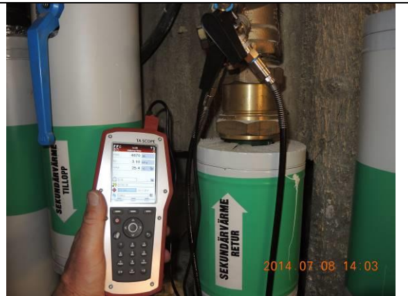
Bild 10. Flödet i VS-krets uppmättes till 4600 l/h vid besök 8 juli 2014.
