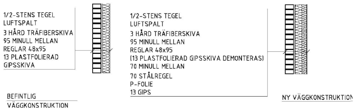
Figur 3 Ytterväggskonstruktionen före och efter åtgärd. Luftspalten i den befintliga väggkonstruktionen var fylld med karbamidskum någon gång på 1980-talet.
