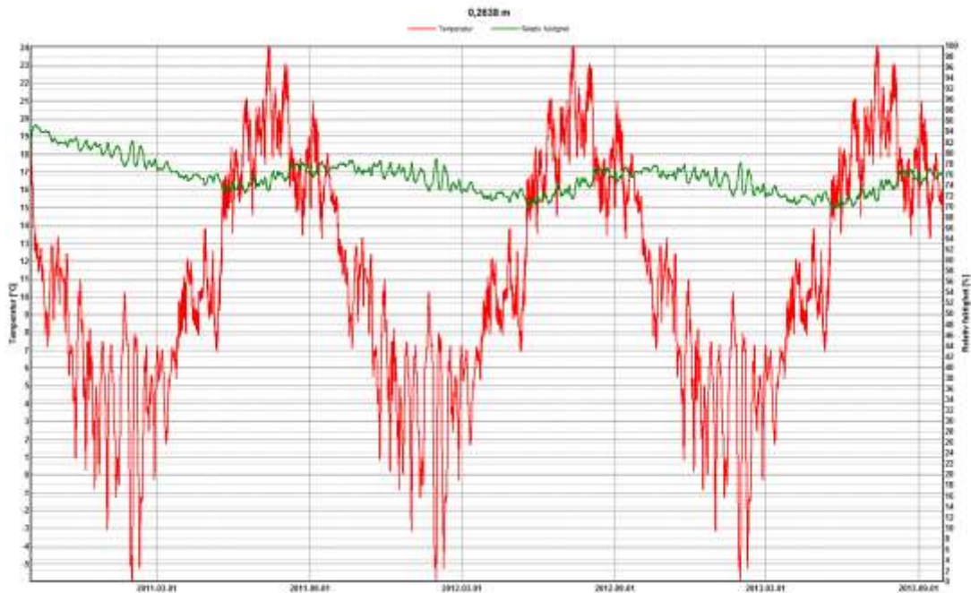
Figur 6 – Temperatur och RF i skiktgränsen mellan isolering och puts då PE-folie använts och innetemperatur satts till 28 °C.
