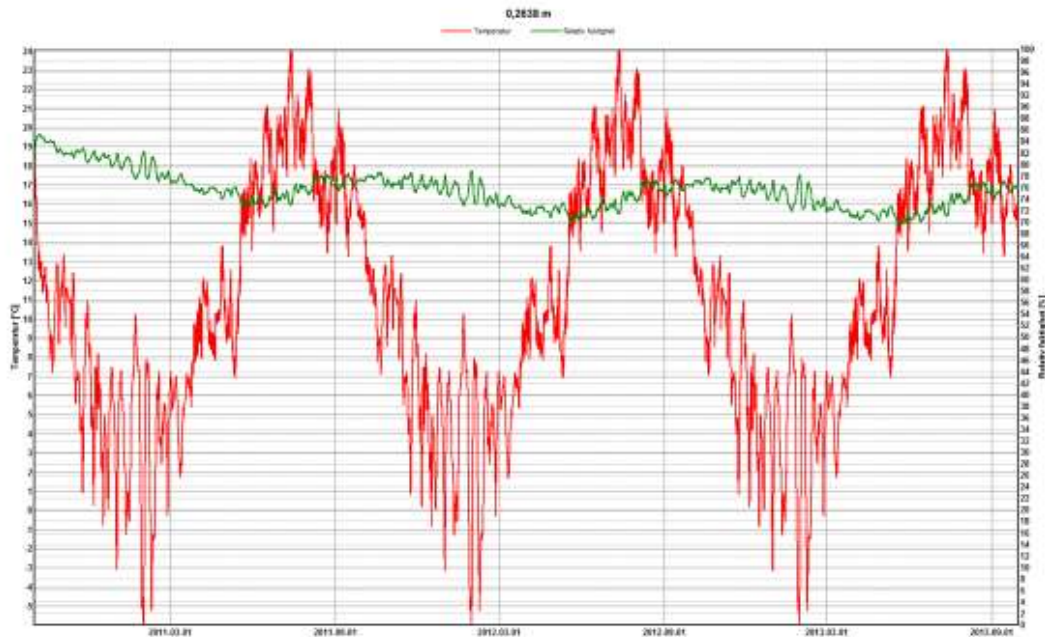
Figur 5 – Temperatur och RF i skiktgränsen mellan isolering och puts då PE-folie använts.
